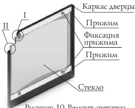
Рисунок 10. Ремонт светопрозрачного экрана дверцы.
